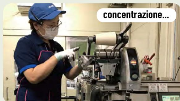
Il controllo dei tamburi. Controlliamo ogni singolo tamburo in ciascun elemento prima dell'installazione sulle unità bobinatrici. Il sistema PAC che impiega tamburi speciali viene spesso selezionato dai nostri clienti, perciò eseguiamo controlli completi per assicurarne ulteriormente l'affidabilità.
