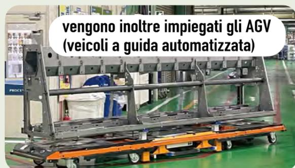
All'interno dello stabilimento di Kaga vengono impiegati gli AGV (veicoli a guida automatizzata). Essi vengono utilizzati per la consegna dei componenti alla sezione di assemblaggio. Facciamo uso delle nostre tecnologie di automazione per i nostri processi produttivi.
