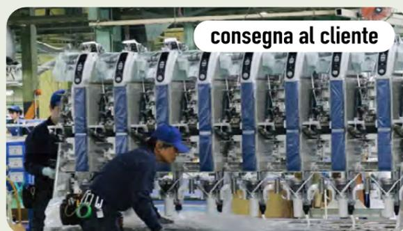
In fine, i telai vengono imballati e approntati per la spedizione. La cassetta di fine corsa, la cassetta del soffiatore, il levarocche automatico e l'alimentatore continuo di spole vengono ultimati su linee separate e raggruppati contemporaneamente per la spedizione.
